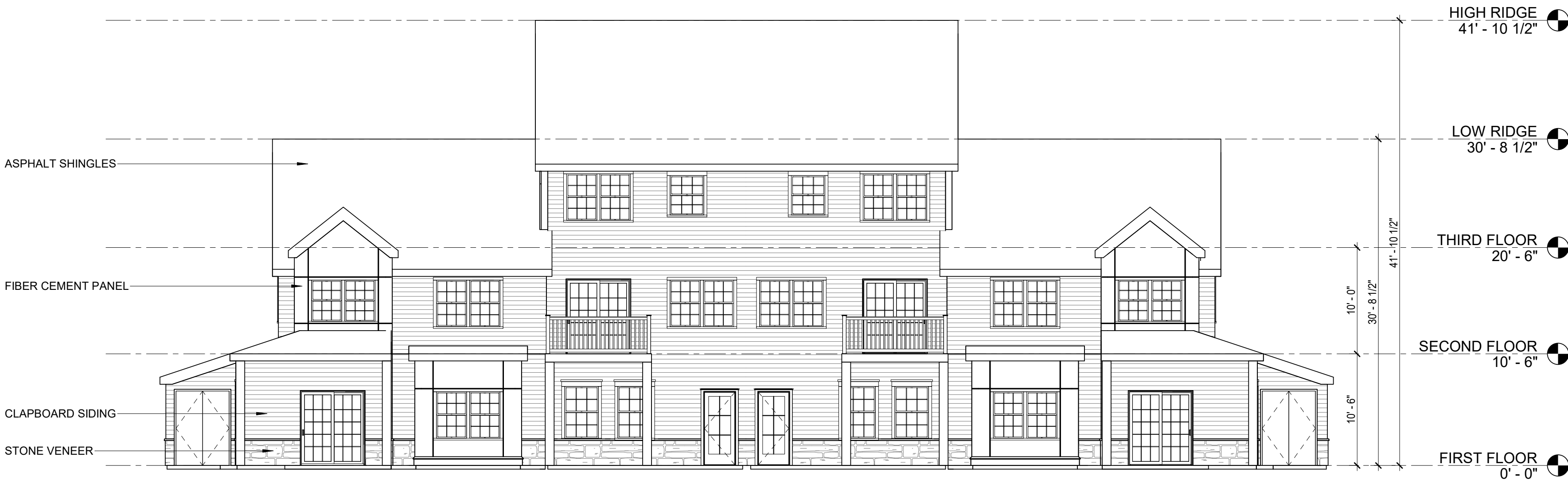
NORTH ELEVATION - TYPE B SCALE: 1/8" = 1'-0" 3
